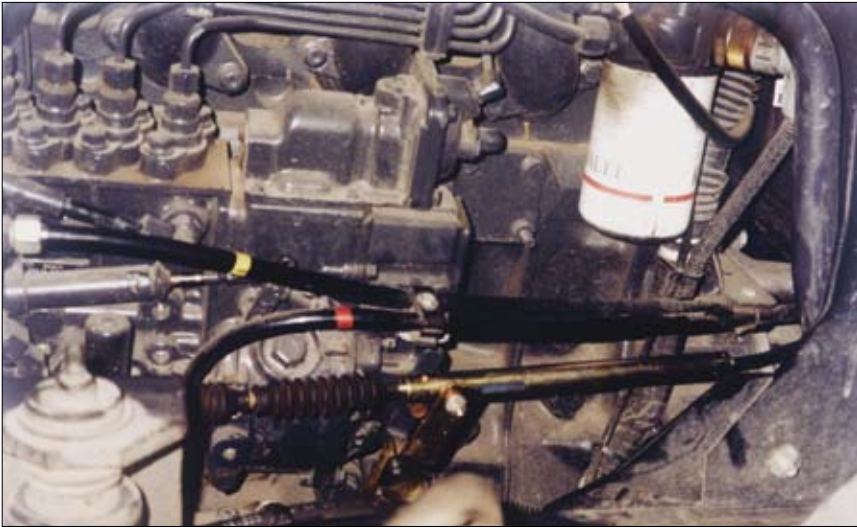
Element wykonawczy ogranicznika STURDY 89E zamocowany przy pompie wtryskowej
